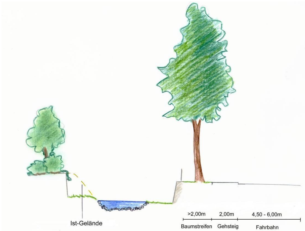
Abbildung 40: Profilschema: Uferzone mit harter Verbauung (Steinwurf) im Ortsgebiet
